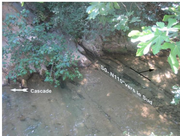
**Fig. 14. Joints de stratification élargis des marno-calcaires du Bathonien - Lit du Las à l'aval du seuil**
