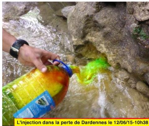
**Fig. 17. Injection de fluorescéine dans la perte de Dardennes (lit du Las) lors de l'opération de traçage de 2015**
