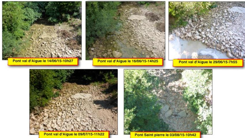
**Fig. 19. Observations des débits sous les ponts lors de l'opération de traçage de 2015**
