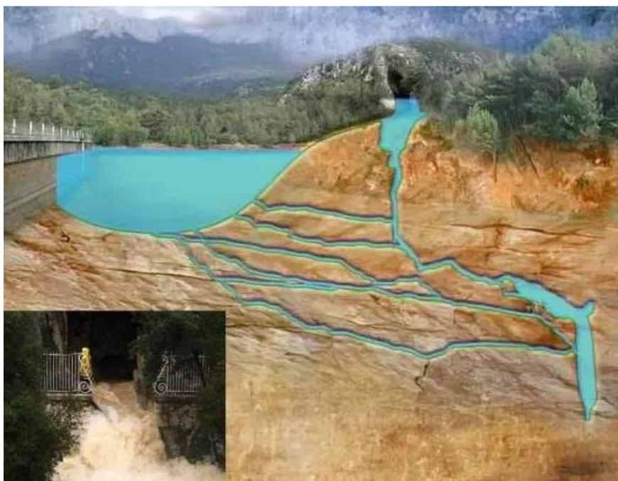
**Fig. 4. Schéma d'alimentation des eaux de la retenue par les sources karstiques en régime noyé**
