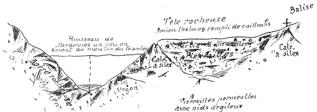
Figure 28 – Schéma de principe de la problématique géologique observée dans le cadre de l'implantation de l'ouvrage de la retenue de Dardennes (in KILIAN M.W., 1909)
